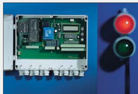
Styrning för mötande trafik MS 410 Mikroprocessorstyrning med värdesanalys. (Inställning, underhåll, feldiagnos.) Programmering med tre knappar på LCD-monitor med text som kan visas på flera språk. (Användning: t.ex. underjordiska garage med körbanereglering och rullgaller med indragsskydd.)
